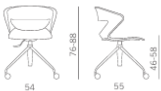
Girevole gas 4 piedi con ruote Versioni: AB AN ACC Swivel 4 legs on castors , gaslift Versions: AB AN ACC
